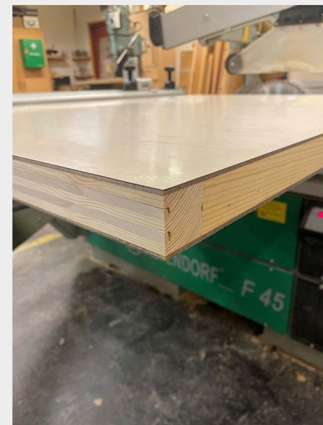
Trästavar & MDF skapar en bra bas för vidare användning.
