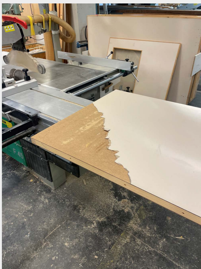
Lamineringen var enkel att skrapa bort, då kom MDF:en fram.
