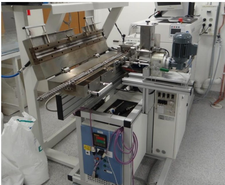
Figur 7 Extruder i labbskala där man kan forma plast i smält form.
