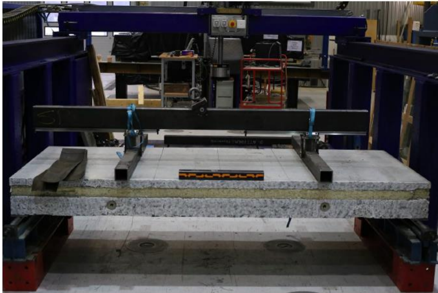
Figur 18 Provuppställning för provning av ett sandwich-elements böjhållfasthet (Foto: RISE). Elementet är 240 cm långt och vilar på två stöd i ändarna, medan lasten appliceras kontrollerat via de två balkarna på ovansidan (provningen är alltså fyrapunkts böjhållfasthetsprovning). Sandwich-elementet består underifrån och upp av en innerpanel i betong, isolering och slutligen en ytterpanel i betong. Sidorna på betongpanelerna har sprayats med specialfärg för att göra det lättare för det digitala töjningssystemet att hitta objekt att jämföra från foto till foto.
