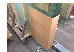
Bild 1. Bottenskiva av wellpapp, mässnit eller motsvarande skyddar och förhindrar att mindre delar faller igenom lastpalan.
